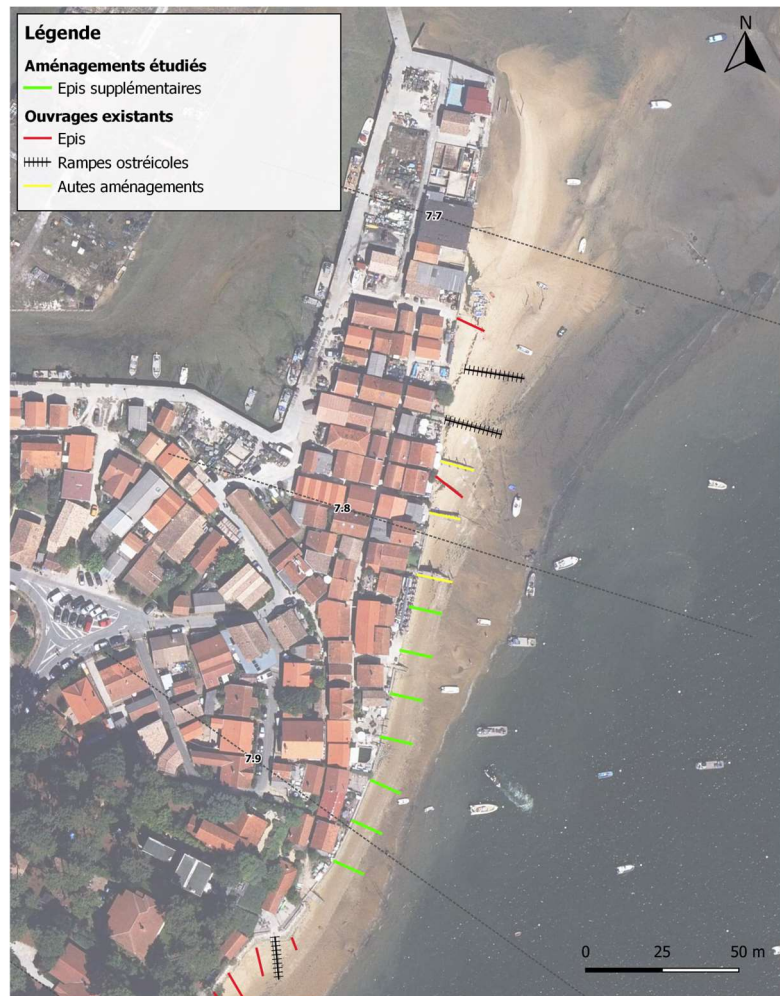
FIGURE 40. LOCALISATION DES OUVRAGES AJOUTES.
