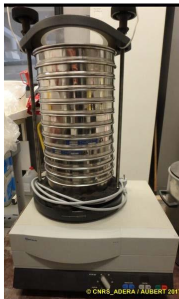
Figure11 : Colonne de tamis normalisée AFNOR sur tamiseuse Retsch
