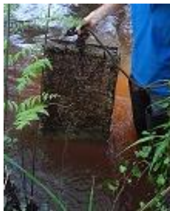
Figure 18. Cage d'exposition pour les corbicules.
