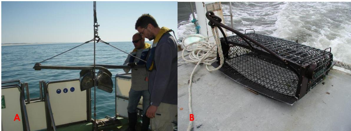
Figure 2 : Prélèvements à la benne Van Veen (A) et à la drague à coquilles (B)
