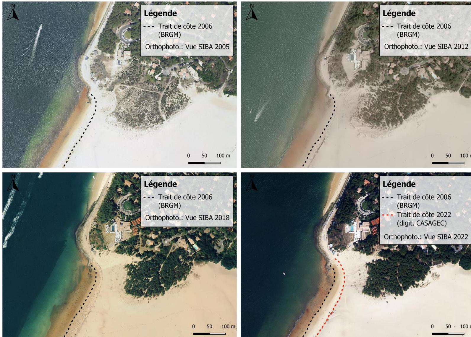
Figure 18. Evolution du phénomène d'érosion dans le secteur du musoir de la Corniche (Fond de plan : Orthophotographie du SIBA 2005, 2012, 2018 et 2022).
