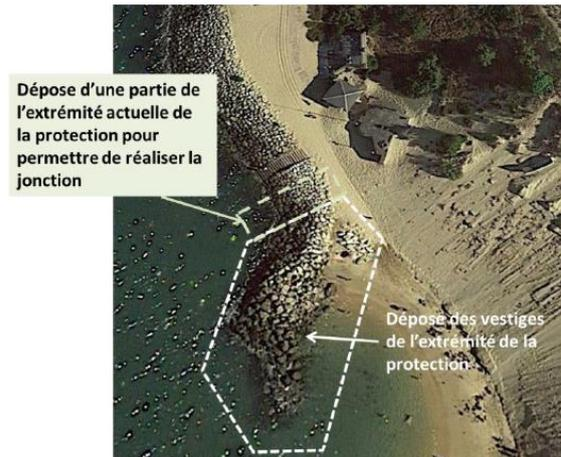
Figure 3. Localisation des zones d'enrochements à déposer (ARTELIA 2022).
