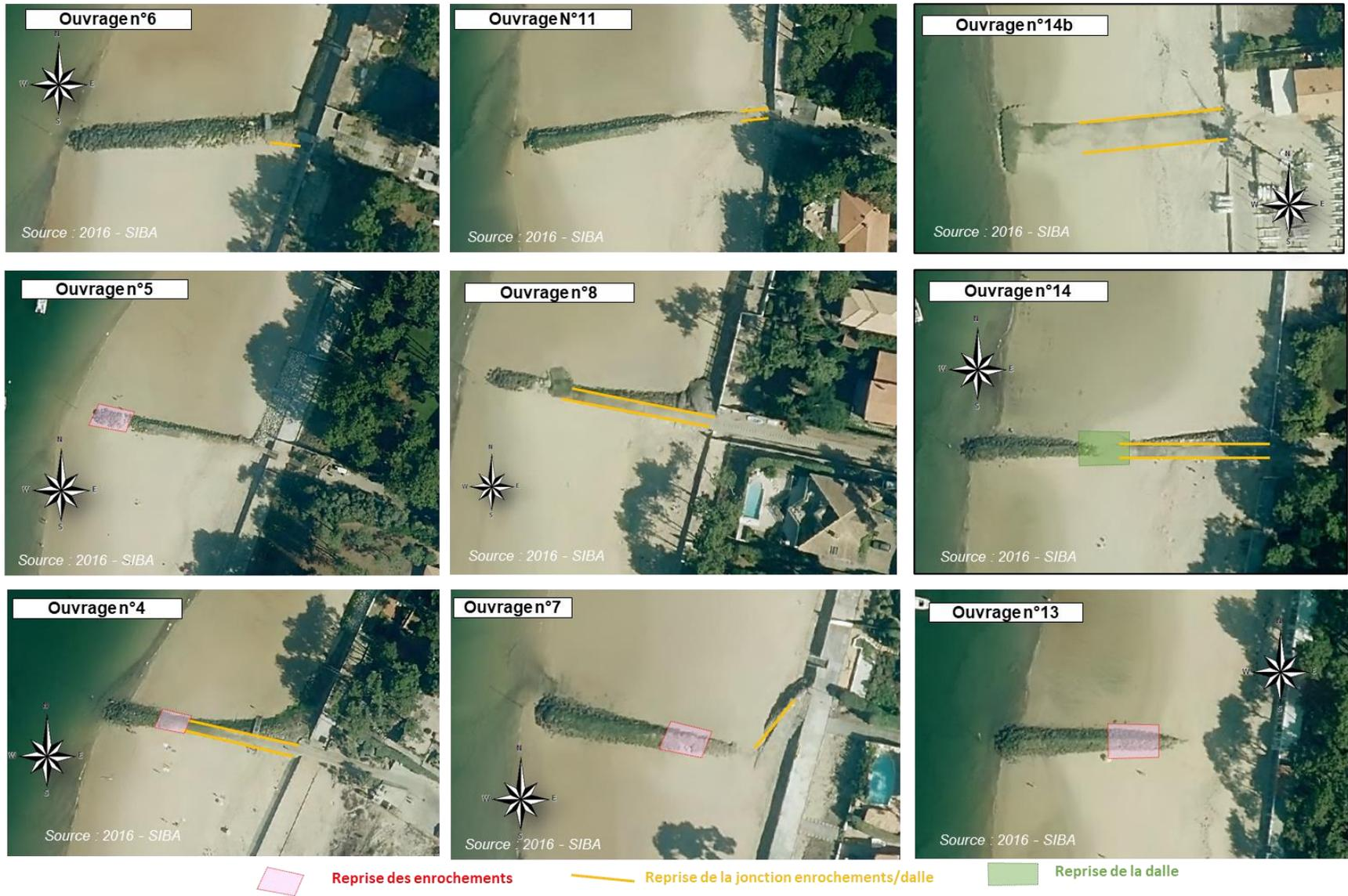
Figure 5 : Confortement localisé – visualisation des travaux
