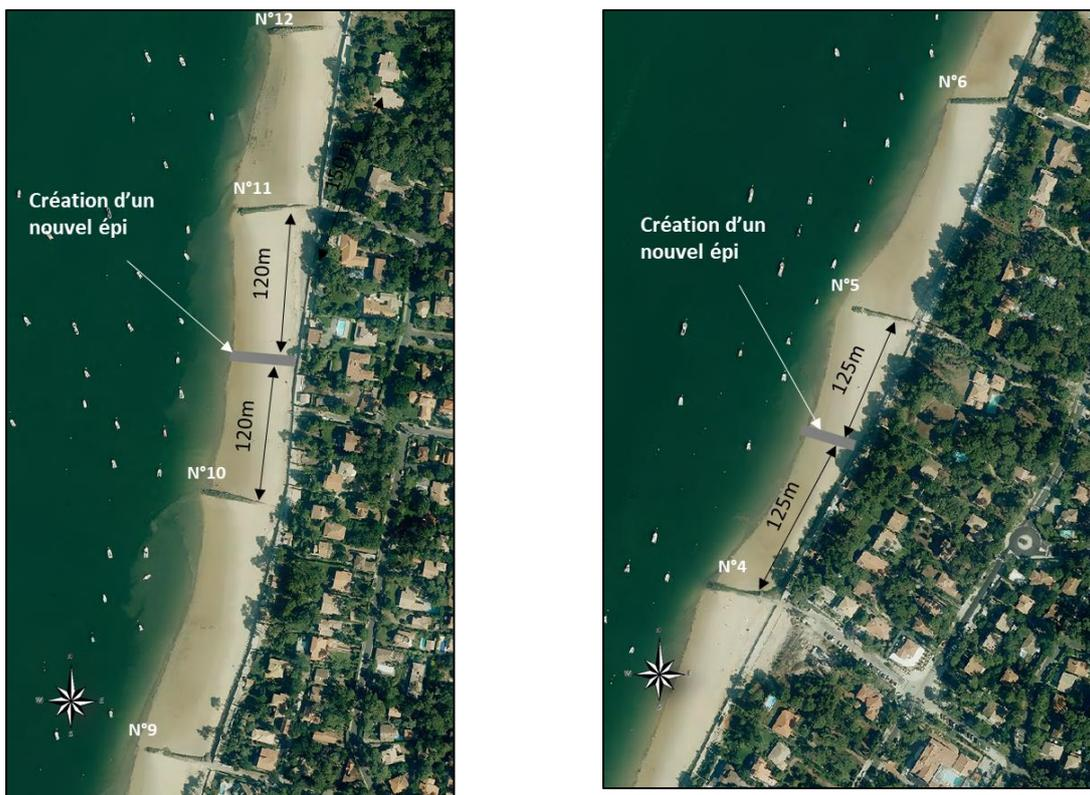
Figure 14 : Proposition d'amélioration du dispositif de protection
