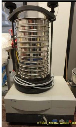
Figure 29 : Colonne de tamis normalisée AFNOR sur tamiseuse Retsch
