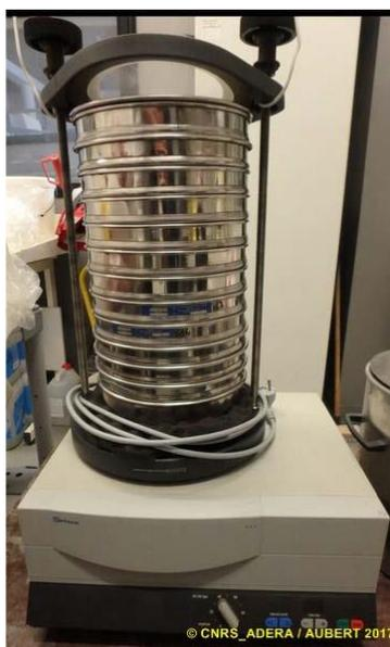
Figure 19 : Colonnes de tamis normalisées AFNOR sur tamiseuse Retsch
