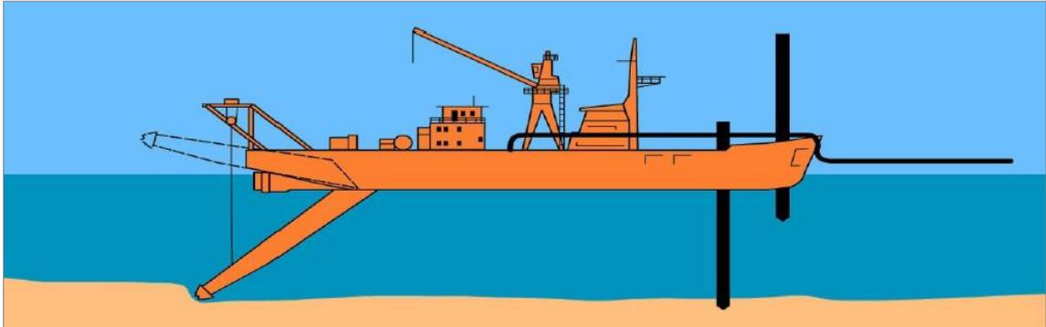
Figure 55 : Schéma de principe du dragage par une drague aspiratrice stationnaire (source : IFREMER).
