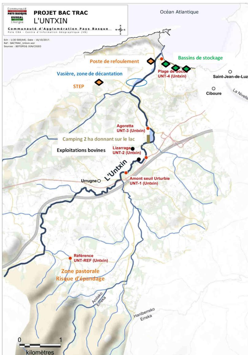
Figure 20. Cartographie des stations d'échantillonnage et des sources potentielles de contamination présentant un risque significatif sur le bassin versant de l'Untxin.
