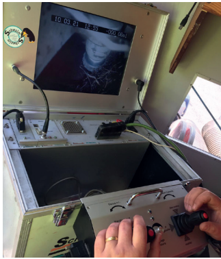
Utilisation d'un robot pour fraisage de racines sur réseau : Gujan-Mestras
