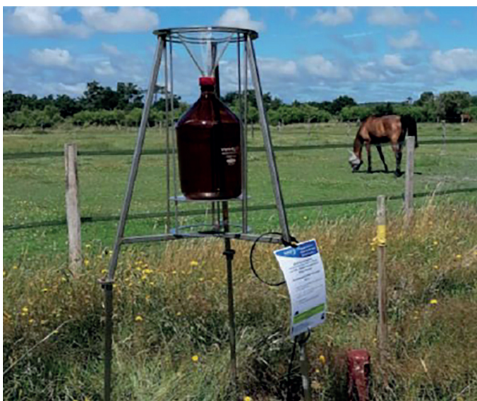
Jauge de suivi des retombées atmosphérique installée à Arès.
