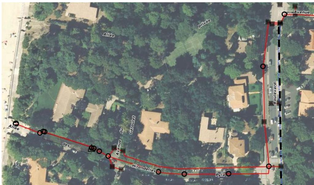
**Figure 54.** Réseau pluvial au niveau du bassin versant des Hironnelles. En rouge, le réseau pluvial qui achemine les eaux pluviales au bassin d'infiltration des Hironnelles. En noir pointillé, la tranchée drainante qui récupère les eaux de la route départementale.
