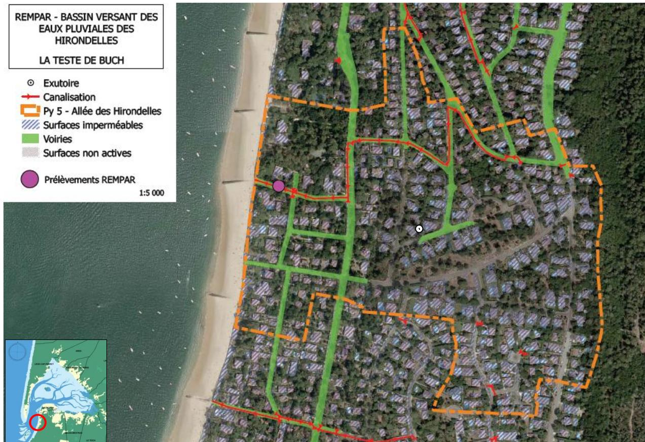
**Figure 9.** Bassin versant des eaux pluviales raccordées au bassin d'infiltration de l'avenue des Hirondelles (Pyla-Sur-Mer, commune de La Teste de Buch) © SIBA. Le bassin versant est délimité par les traits orange.
