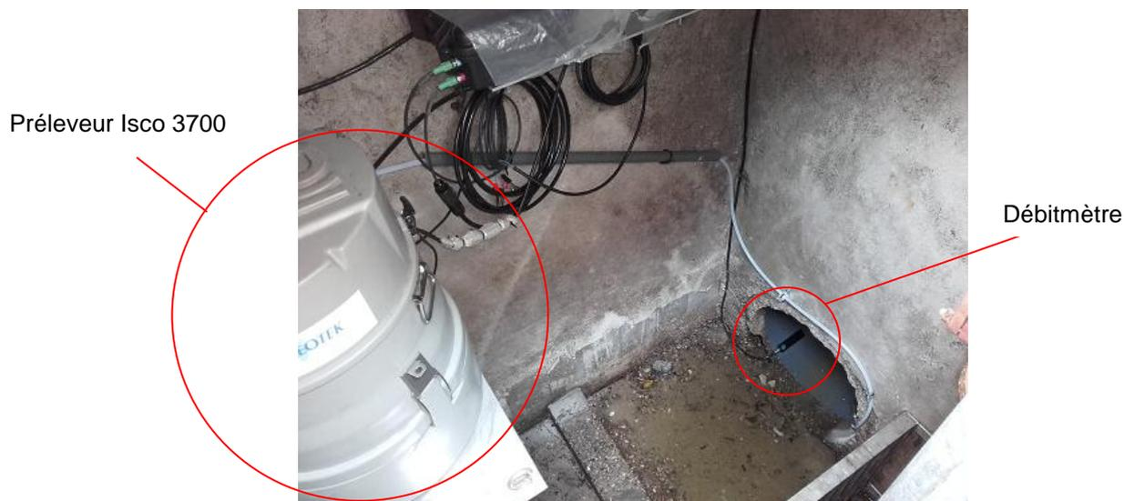
Figure 28. Débitmètre positionné dans la canalisation. © SIBA.
