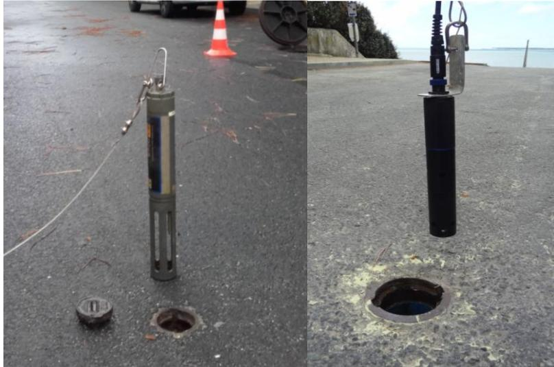
**Figure 23.** Sondes multiparamètres utilisées (Sonde Ysi à gauche et Aquaread à droite). © SIBA
