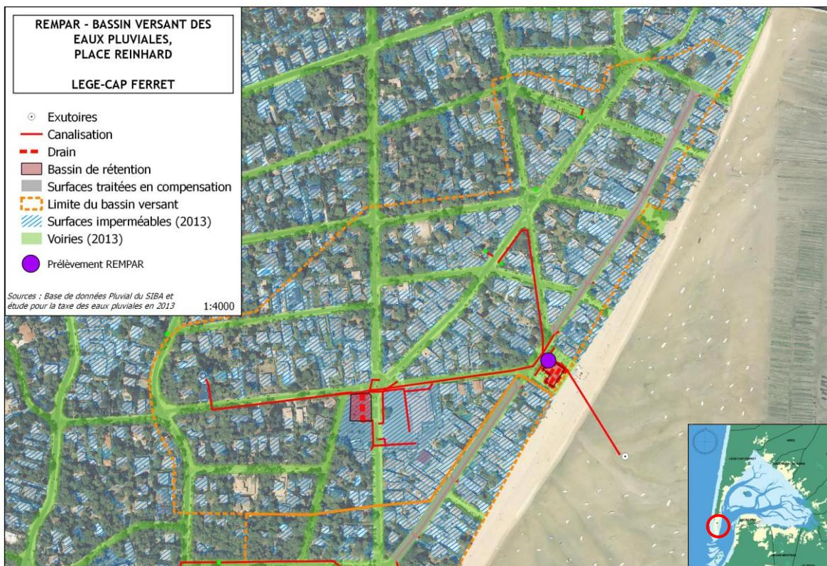
**Figure 11.** Bassin versant des eaux pluviales raccordées au bassin d'infiltration de la place Walther Reinhard (Commune de Lège-Cap-Ferret). Le bassin versant est délimité par les traits orange.
