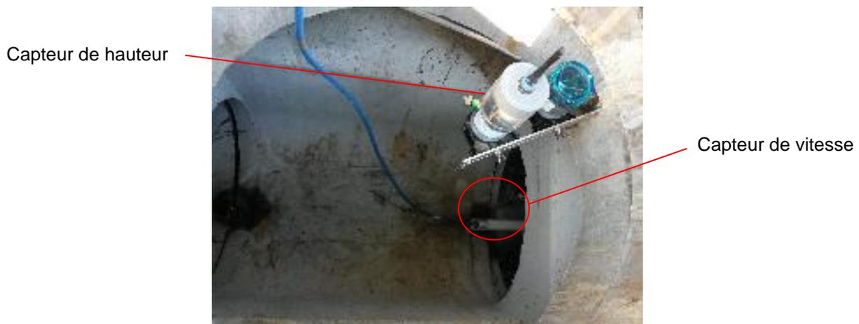
**Figure 19.** Capteur de vitesse et capteur de hauteur à ultrasons en position. © SIBA.
