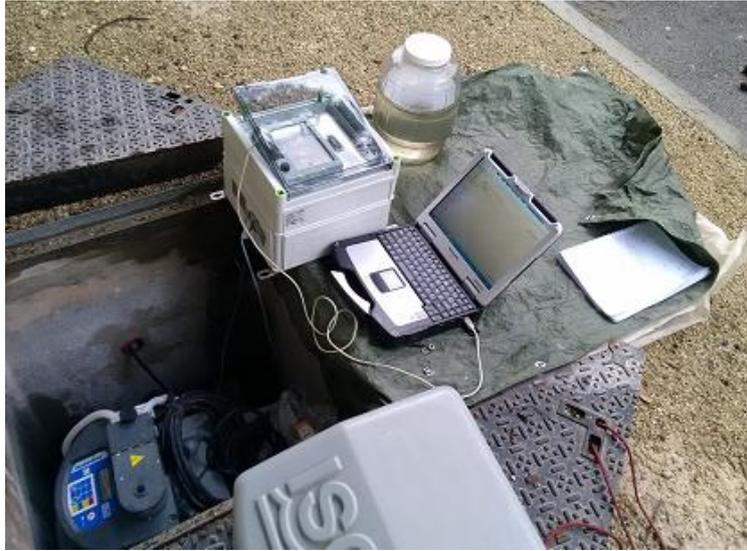
Figure 20. Capteur de hauteur radar et mémographe. © SIBA.
