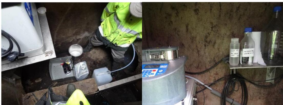
**Figure 76.** Procédure de nettoyage et réalisation des blancs de prélèvement sur site.
