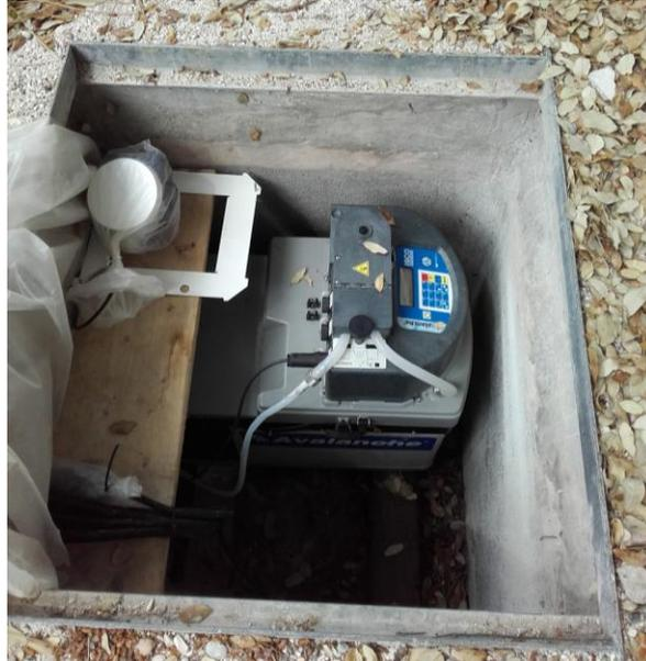
**Figure 17.** Préleveur automatique installé dans le regard aménagé dans la voirie. © SIBA.
