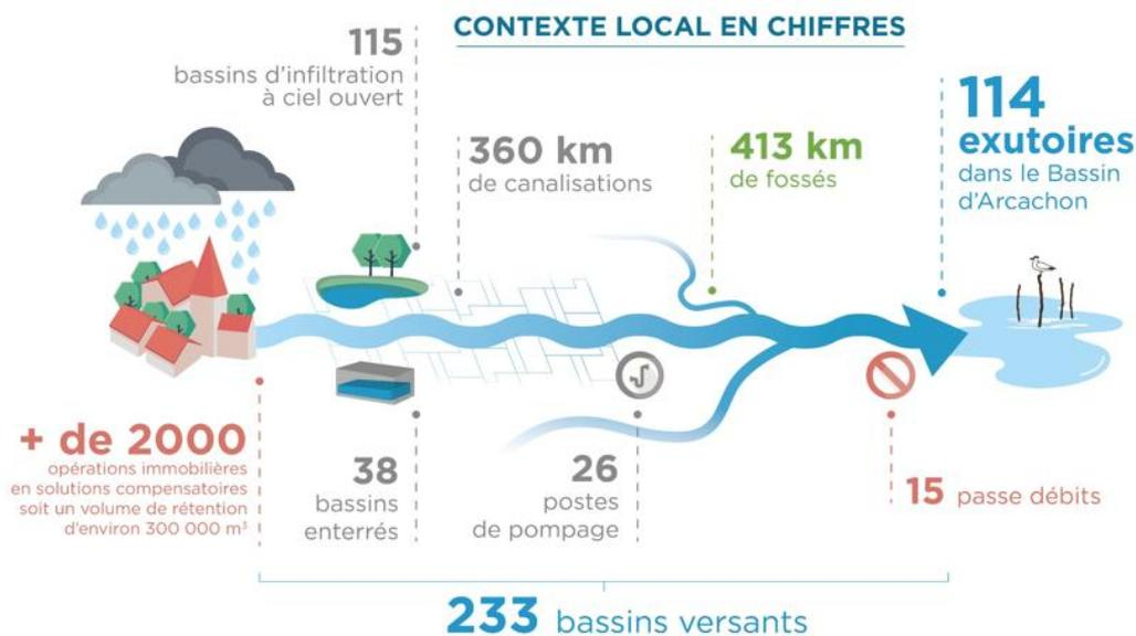
**Figure A.** Schéma de principe des solutions compensatoires implantées sur le réseau d'eaux pluviales en protection du Bassin d'Arcachon.
