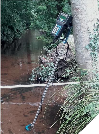
L'appareil recalcule ensuite le débit à partir de la vitesse moyenne, de la profondeur du cours d'eau et de la section (largeur) de la rivière.
