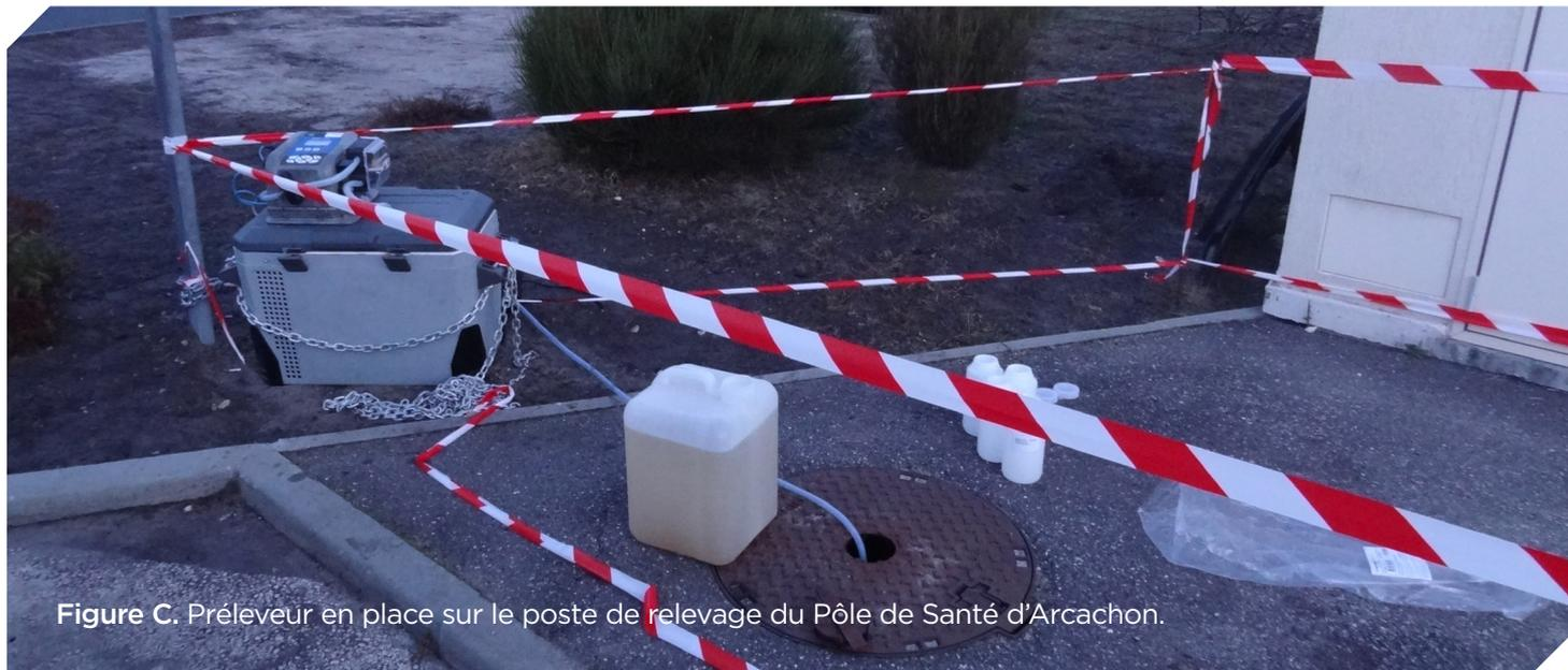
Figure C. Prélèveur en place sur le poste de relevage du Pôle de Santé d'Arcachon.
