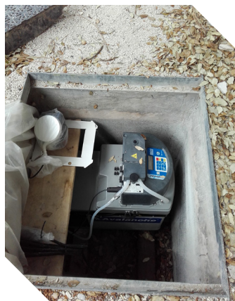
Figure 6. De gauche à droite, préleveur automatique, capteur de hauteur à ultrasons et sonde.
