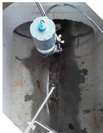
Figure 6. De gauche à droite, préleveur automatique, capteur de hauteur à ultrasons et sonde.
