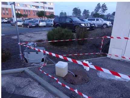
Figure 14. Prélèveur en place sur le poste de relevage du Pôle de Santé.
