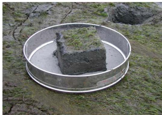
**Figure 2 : Echantillon prélevé au cadre sur un tamis de 1 mm de maille.**
