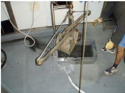
**Figure 3 : Prélèvement dans le chenal à la benne Van Veen.**
