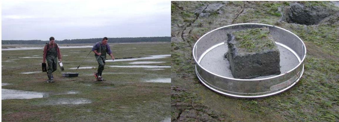
Figure 5 : Echantillonnage au carottier dans l'herbier à Z. noltii
