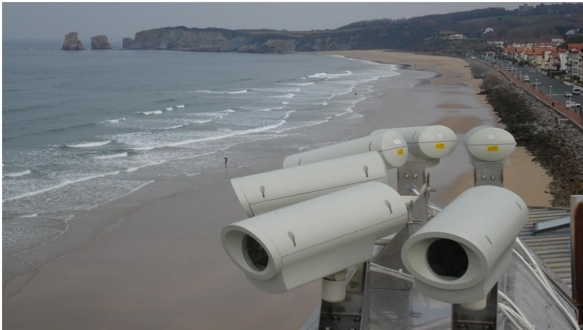
Figure 1 : Exemple de déploiement du système vidéo initial sur le littoral d'Hendaye Plage. 6 Caméras sont nécessaires pour couvrir un angle de 180°.
