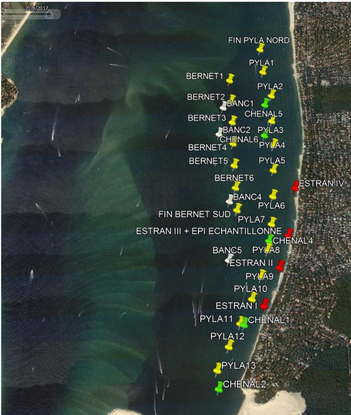
**Figure 1 : Localisation des prélèvements (fonds de carte : Google Earth). En jaune (BERNET et PYLA) : à la drague ; en blanc ou vert (CHENAL et BANC) : à la benne Van Veen ; en rouge (ESTRAN) : stations à pied. Les positions sont en Annexes 1 & 2.**
