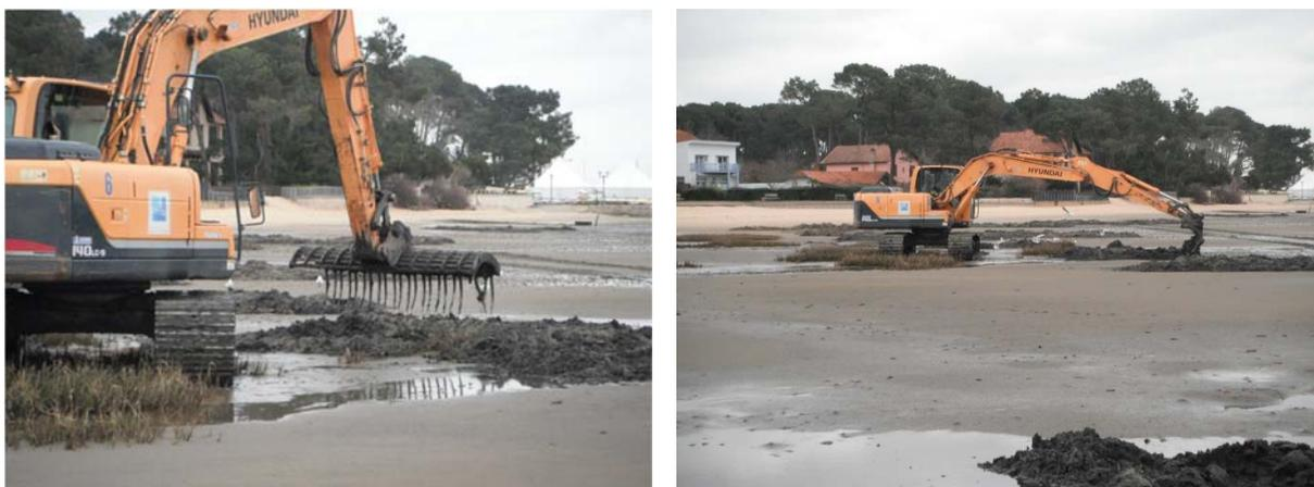
**Figure 4 : Pelleteuse avec godet à griffes utilisée par HPL Environnement sur la plage de Claouey, en février 2015 (Thevand, 2015).**
