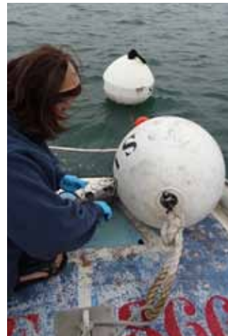
Installation des DGT sur une bouée au Banc d'Arguin.
