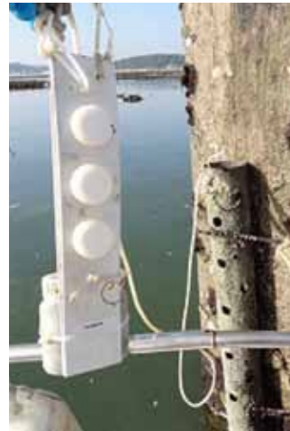
Fig. 3 - DGT dans leur support d'installation.
