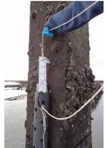
Installation des DGT sur une balise de navigation.
