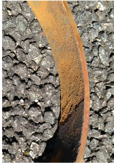
conduite de refoulement du PR Malakoff corrosion intérieure
