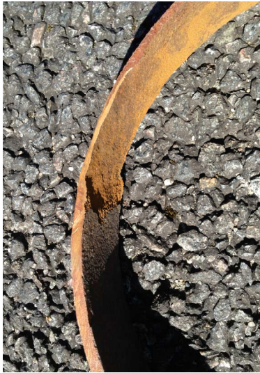
conduite de refoulement du PR Malakoff corrosion intérieure
