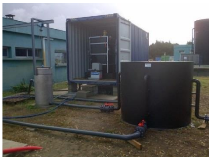
Le bioréacteur à membrane pilote (à gauche) et le laboratoire mobile (à droite)
