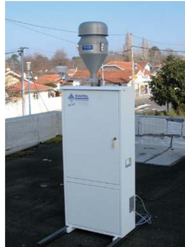
Préleveur d'air DA80 installé sur un toit à Andernos
