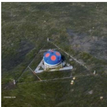
Mesure de la sédimentation au niveau d'un herbier de zostères (Laboratoire EPOC)
