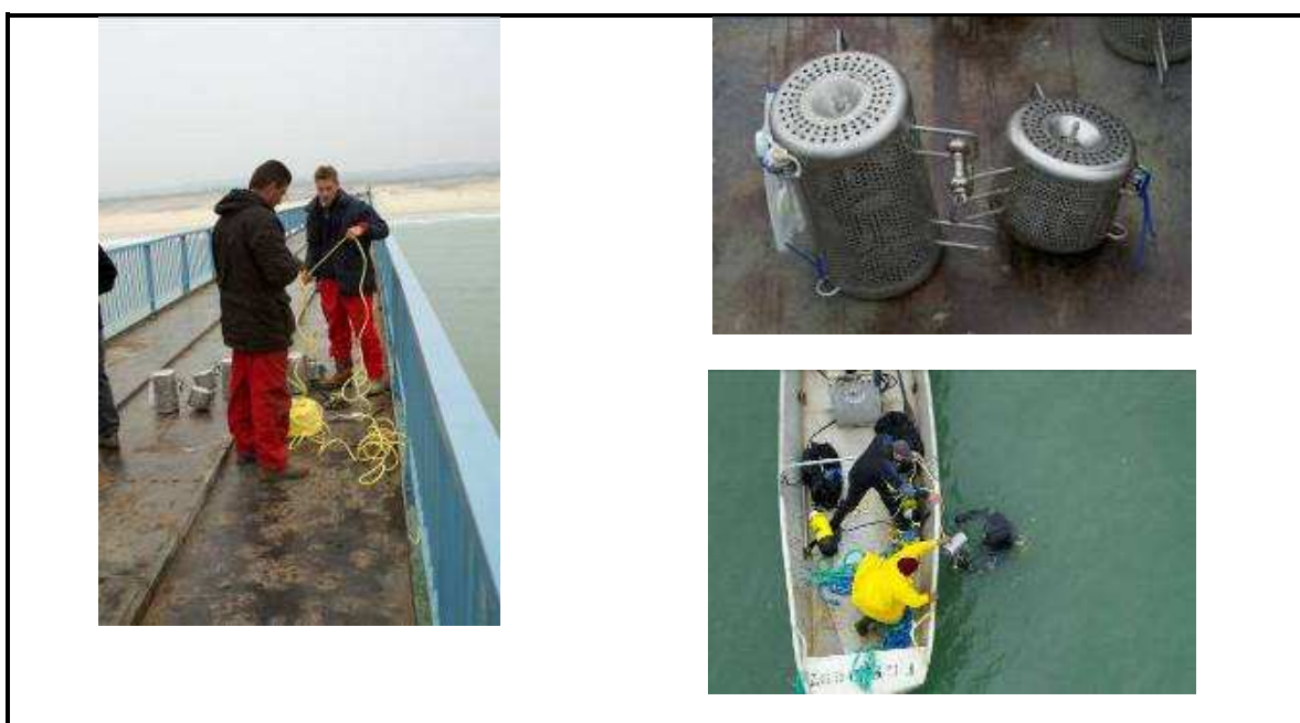
Figure 7 : Fixation des cages contenant les POCIS, Chemcatchers et SPMD et des DGT sur les piles du Wharf.
