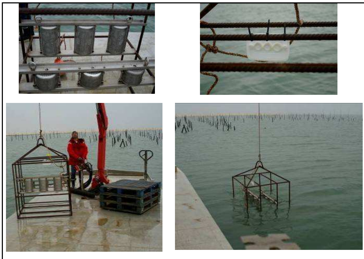
Figure 8 : Mise à l'eau des échantillonneurs sur le site d'Arguin après fixation sur une structure métallique.
