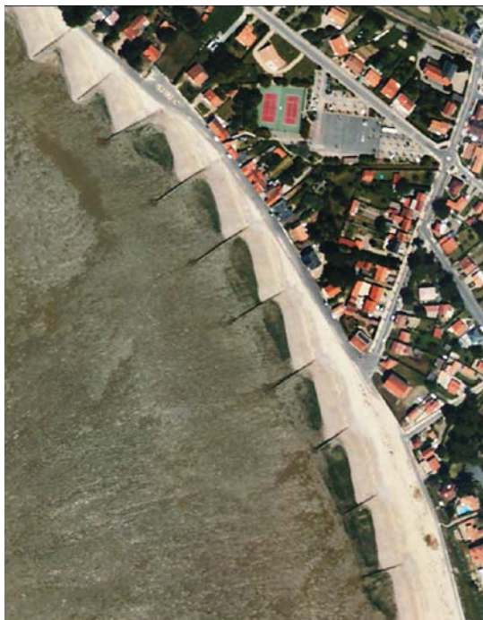
Vue en plan de l'effet d'une portion d'épis (en Loire Atlantique)
