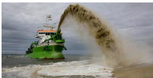
Figure 99. Rechargement de la plage du Pyla par rainbowing (campagne 2009)
