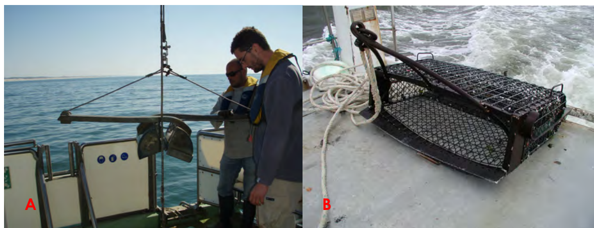
Figure 2 : Prélèvements à la benne Van Veen (A) et à la drague à coquilles (B)
