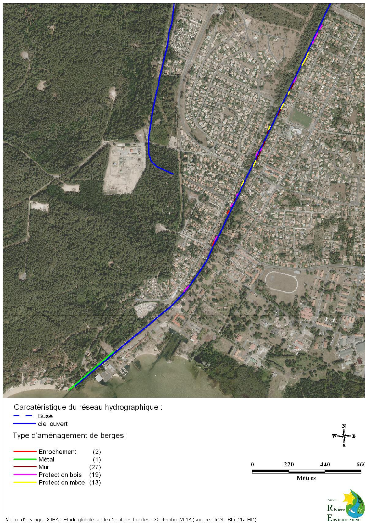
Carte 52 : Type d'aménagement de berges présent sur le tronçon 1 du Canal des Landes.
