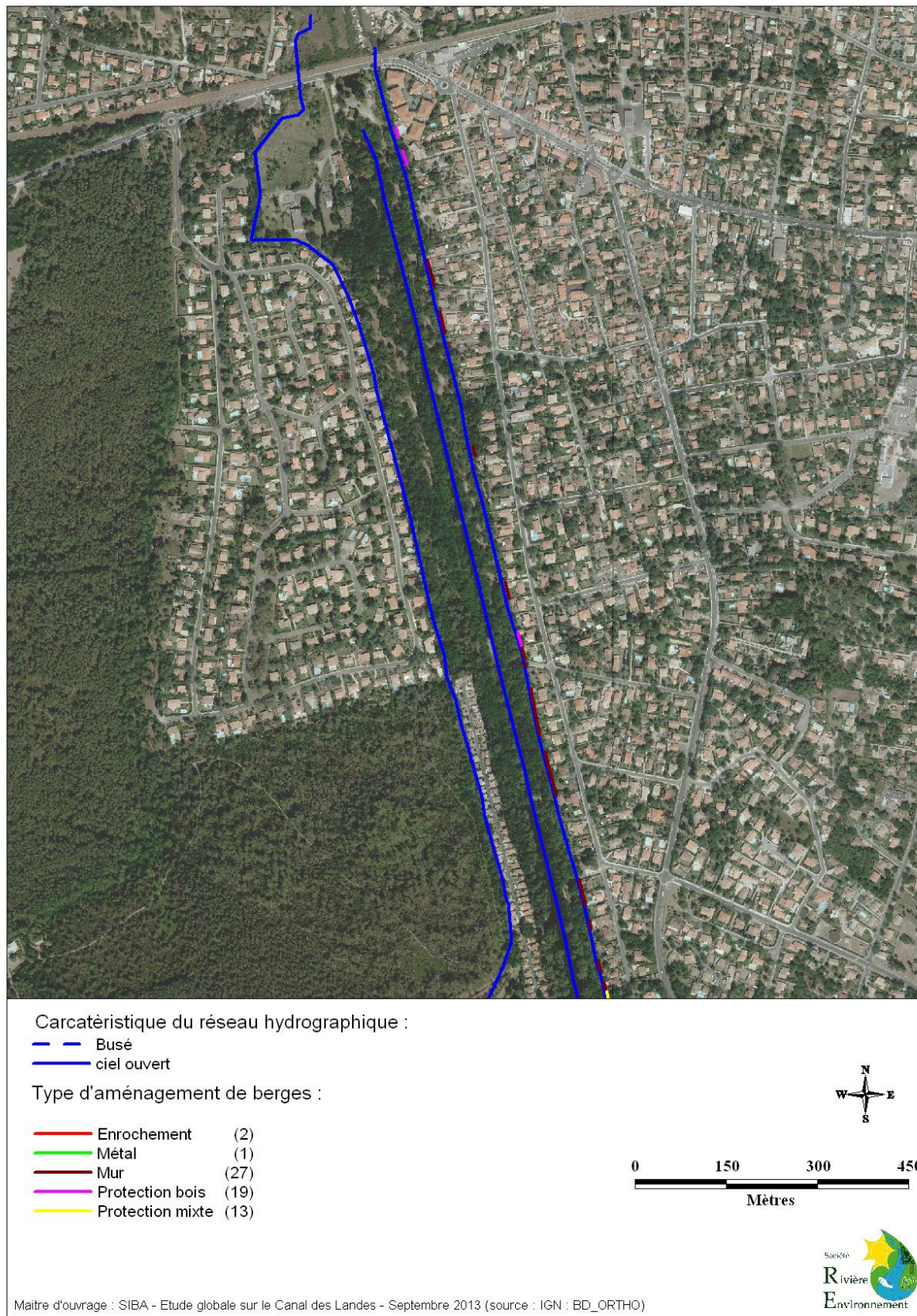
Carte 67 : Type d'aménagement de berges présent sur le tronçon 4 aval du Canal des Usines.
